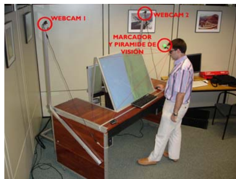
Figura 4. Imagen de la mesa de trabajo utilizada con las gafas de estereo pasivo.
