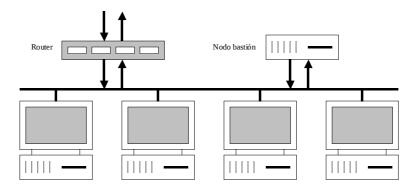
Igual que en el esquema de cortafuegos anterior, el router se encarga de filtrar todos los paquetes provenientes de la red exterior hacia la red interior y viceversa. Por su parte, el nodo bastión consiste en una computadora que ejecuta el servicio de correo electrónico, Web y en general, cualquier programa de usuario que deba permitir el acceso externo. La programación de esta configuración es más compleja. El router debe:
