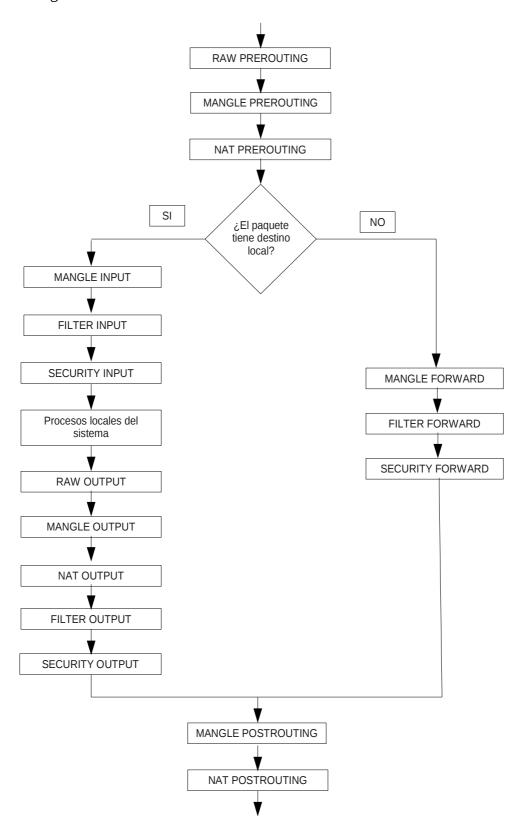
En ella, podemos ver el orden en que actúa cada una de las cadenas de las tablas y, por tanto, como afecta su acción al resto de cadenas de las tablas, pues un paquete modificado por una regla de una cadena de una tabla aparece, para el resto de reglas que la analicen posteriormente, con ese cambio y sin posibilidad de conocer el contenido inicial del paquete.
