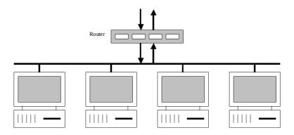
En este cortafuegos el router se encarga de filtrar todos los paquetes provenientes de la red exterior hacia la red interior y viceversa. Sus reglas de filtrado son muy sencillas:
