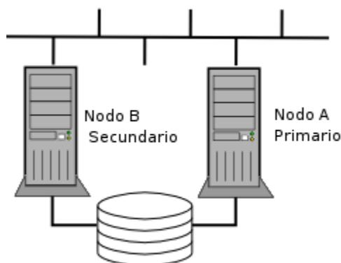
DRBD es un dispositivo de bloques que permite realizar RAID-1 entre dos dispositivos de bloques situados en dos nodos (ordenadores) diferentes<sup>1</sup>, utilizando para ello un enlace de red que suele ser dedicado, permitiendo la salvaguarda de la información y además posibilitando, al utilizar un nodo distinto, el uso de dichos datos por el otro nodo en determinadas situaciones, situaciones que pueden ser un fallo en el nodo principal (sistemas de alta disponibilidad), etc.
