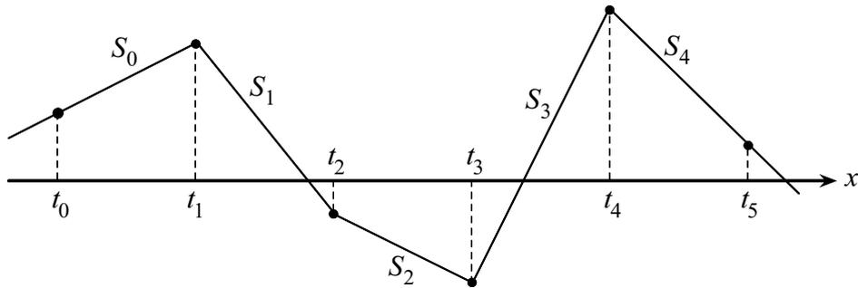
Figura 3.2: Spline de grado 1 con seis puntos.
