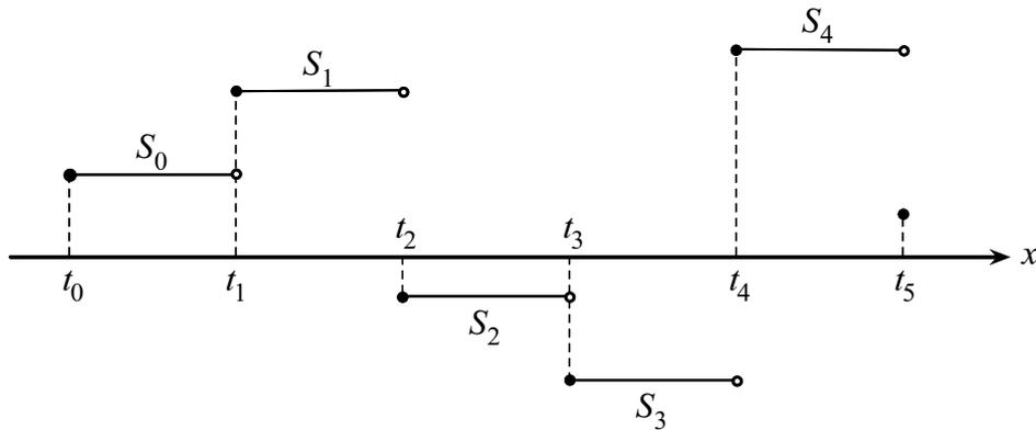
Figura 3.1: Spline de grado 0 con seis puntos.
