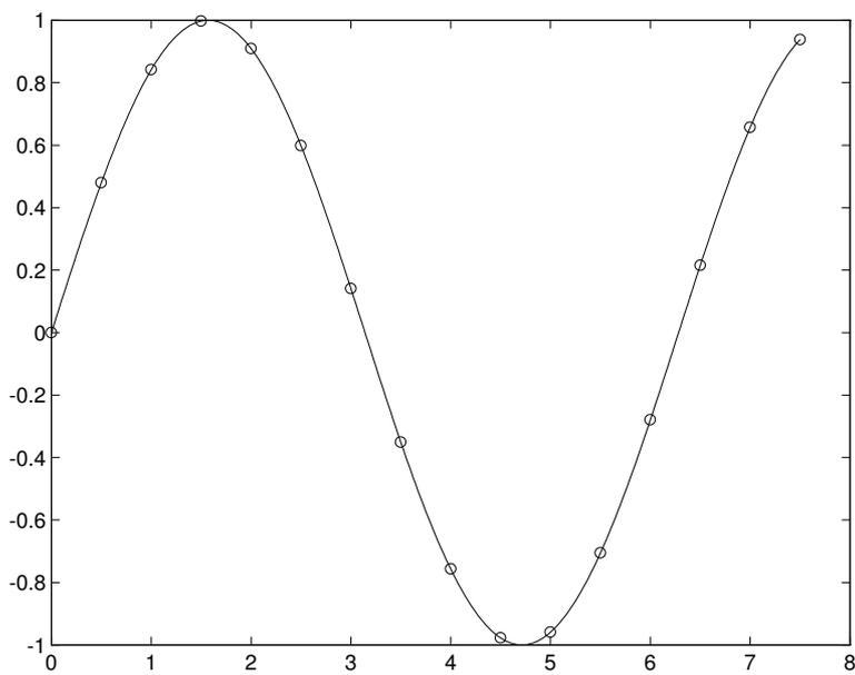
Figura 3.5: Representación de la función  $y = \sin(x)$ . Los círculos representan los valores tabulados de la función y la línea continua los puntos interpolados mediante una función spline cúbica.
