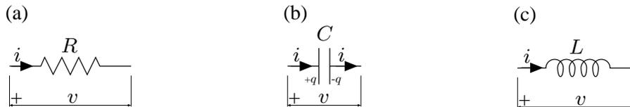
**Figura 5.1.2** Tensión e intensidad en componentes elementales: (a) resistencia, (b) condensador, y (c) autoinducción.
