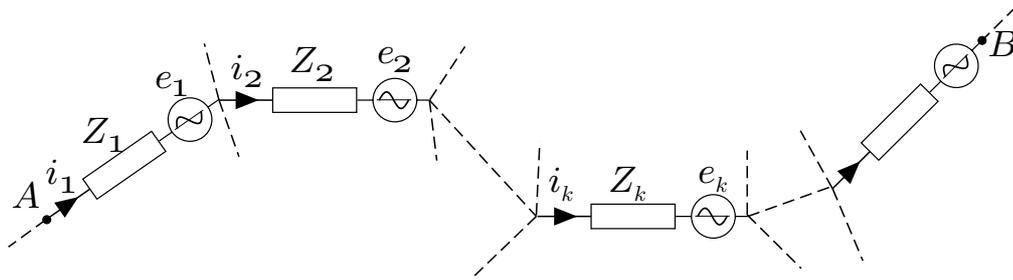
Figura 5.4.1 Caída de tensión en un circuito arbitrario de corriente alterna
