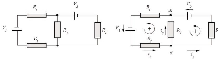
Figura 2.2: Ejemplo de cálculo de un circuito aplicando las leyes de Kirchoff.
