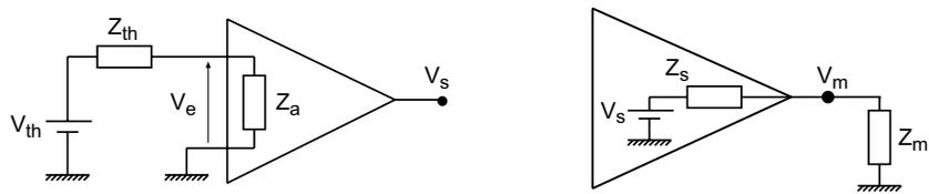
Figura 2.8: Impedancias de entrada y salida de un amplificador.
