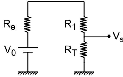
Figura 2.5: Circuito potenciométrico simple.
