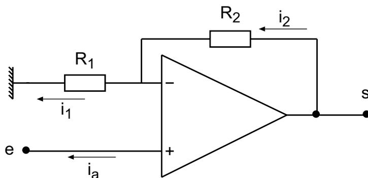
Figura 2.11: Amplificador No inversor.
