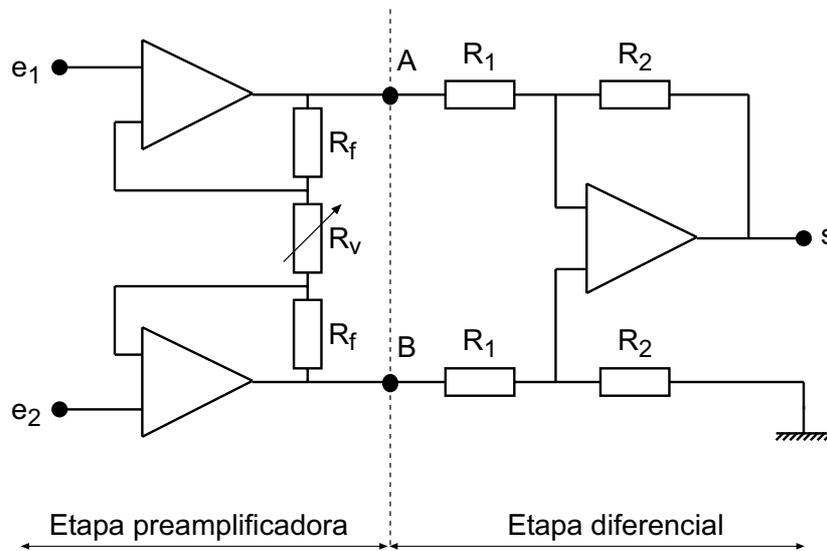
Figura 2.14: Amplificador de Instrumentación.
