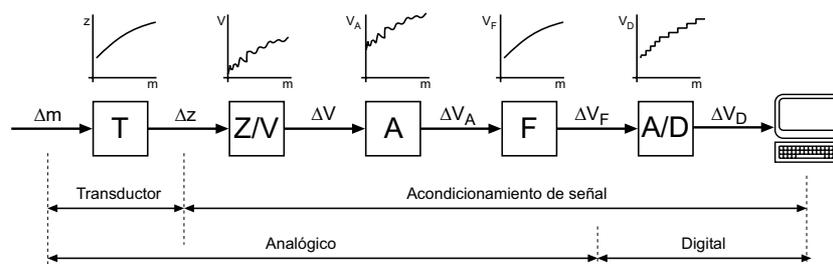
Figura 2.1: Esquema de un sistema de medida.
