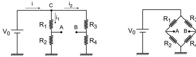
Figura 2.6: Circuito potenciométrico doble o puente de Wheastone.
