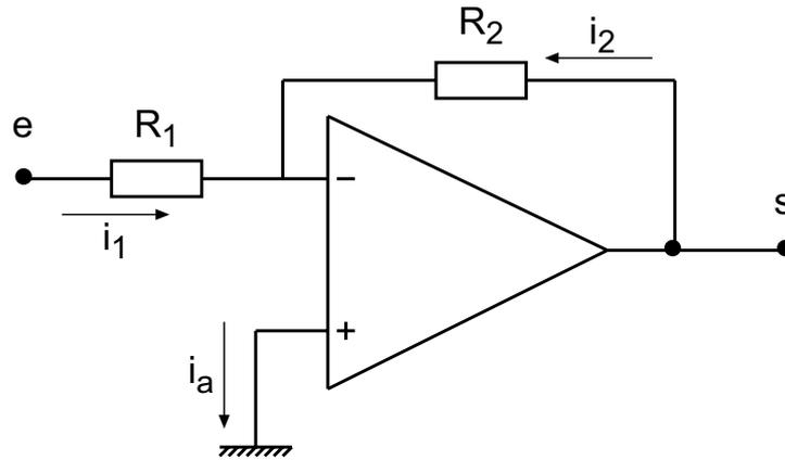
Figura 2.10: Amplificador Inversor.
