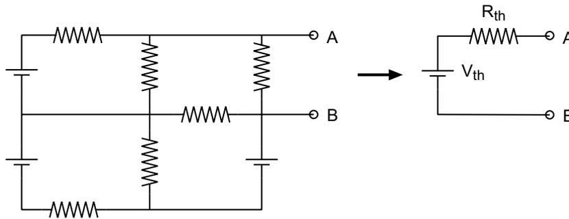
Figura 2.3: Equivalencia de un circuito con su representación Thevenin.
