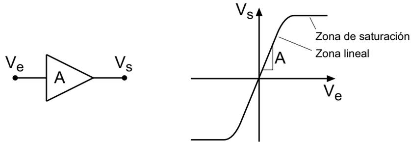
Figura 2.7: Representación y zona de trabajo de un amplificador.
