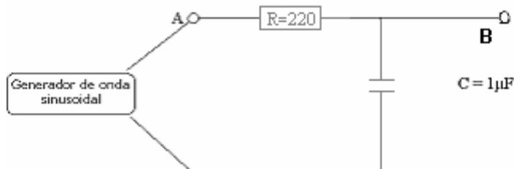
Introducid la señal en A por el canal 1 del osciloscopio y la señal B por el canal 2. Observad simultáneamente las dos señales empleando el modo dual.
