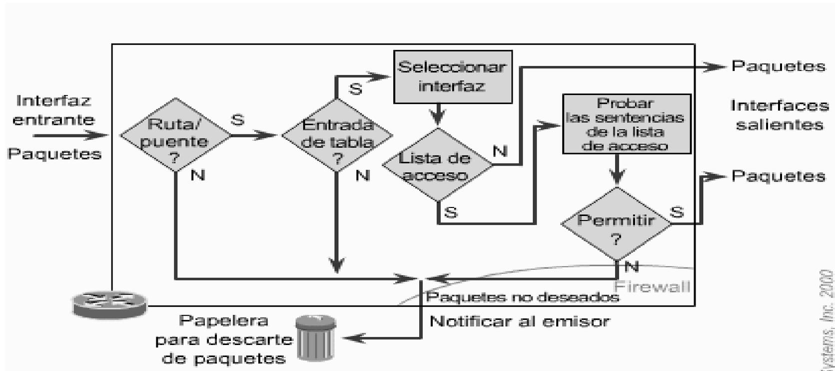
Cuando un paquete accede a una interfaz, el router comprueba si es enrutable o punteable. Comprueba si la interfaz de entrada tiene ACL y si la hay se comprueban las condiciones. Si se permite el paquete, se coteja con las entradas de la tabla ...
