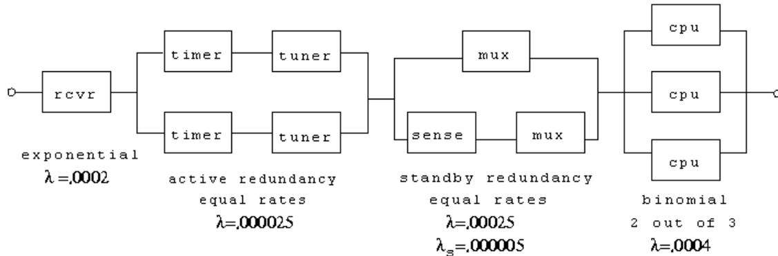
Este modelo es muy sencillo puesto que consta únicamente de 4 bloques en serie parametrizados con alguna de las funciones que SHARPE incorpora: ActiveE, ActiveU, StandbyE, StandbyU, etc.
